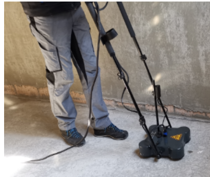
Entmagnetisierung am Bau
