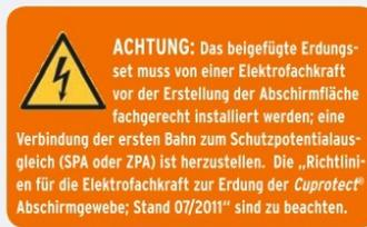
**ACHTUNG:** Das beigegefügte Erdungsset muss von einer Elektrofachkraft vor der Erstellung der Abschirmfläche fachgerecht installiert werden; eine Verbindung der ersten Bahn zum Schutzpotentialausgleich (SPA oder ZPA) ist herzustellen. Die „Richtlinien für die Elektrofachkraft zur Erdung der Cuproprotect® Abschirmgewebe; Stand 07/2011“ sind zu beachten.
